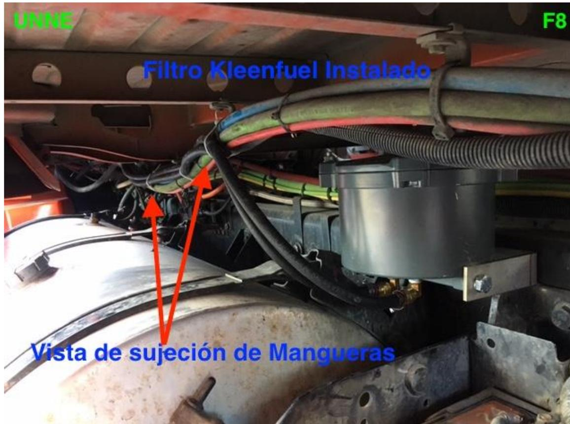
**Filtro KFUEL 65 Instalado y vista Mangueras**
