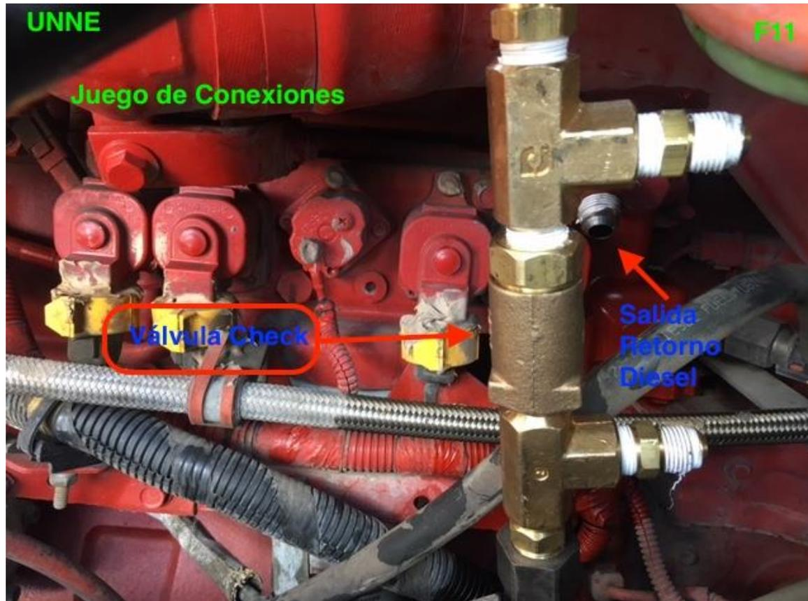
**Conexiones montadas antes de poner mangueras**
