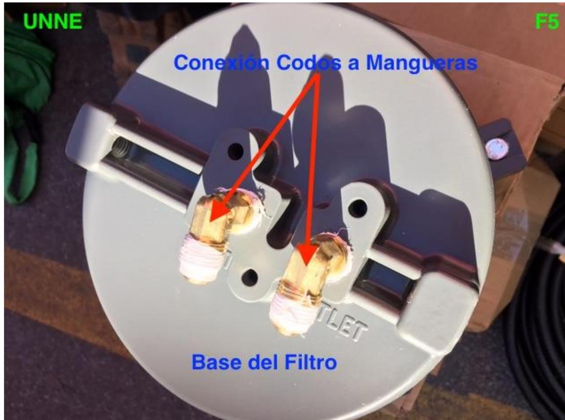
**Vista inferior de la entrada y salida del Diesel**
