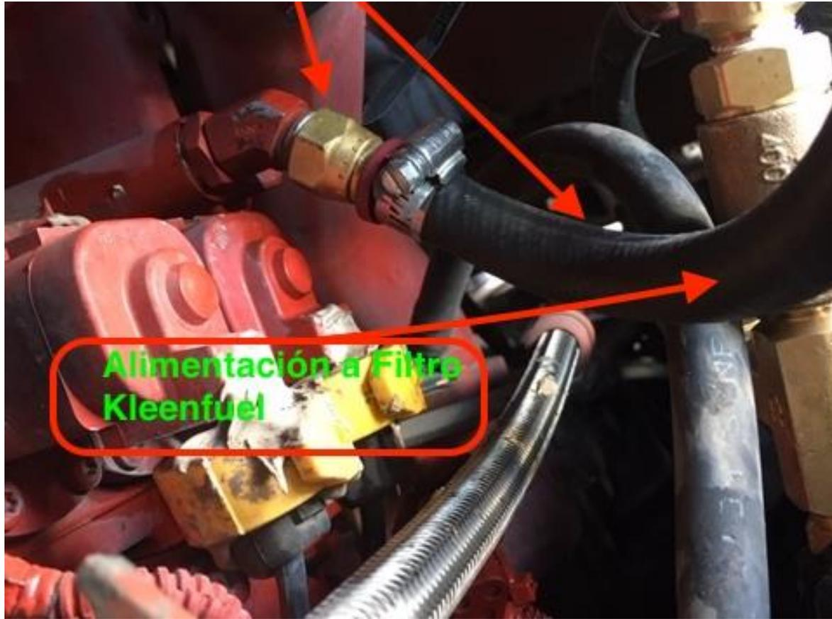
**Instalación conexión y Manguera, al Filtro kfuel65**
