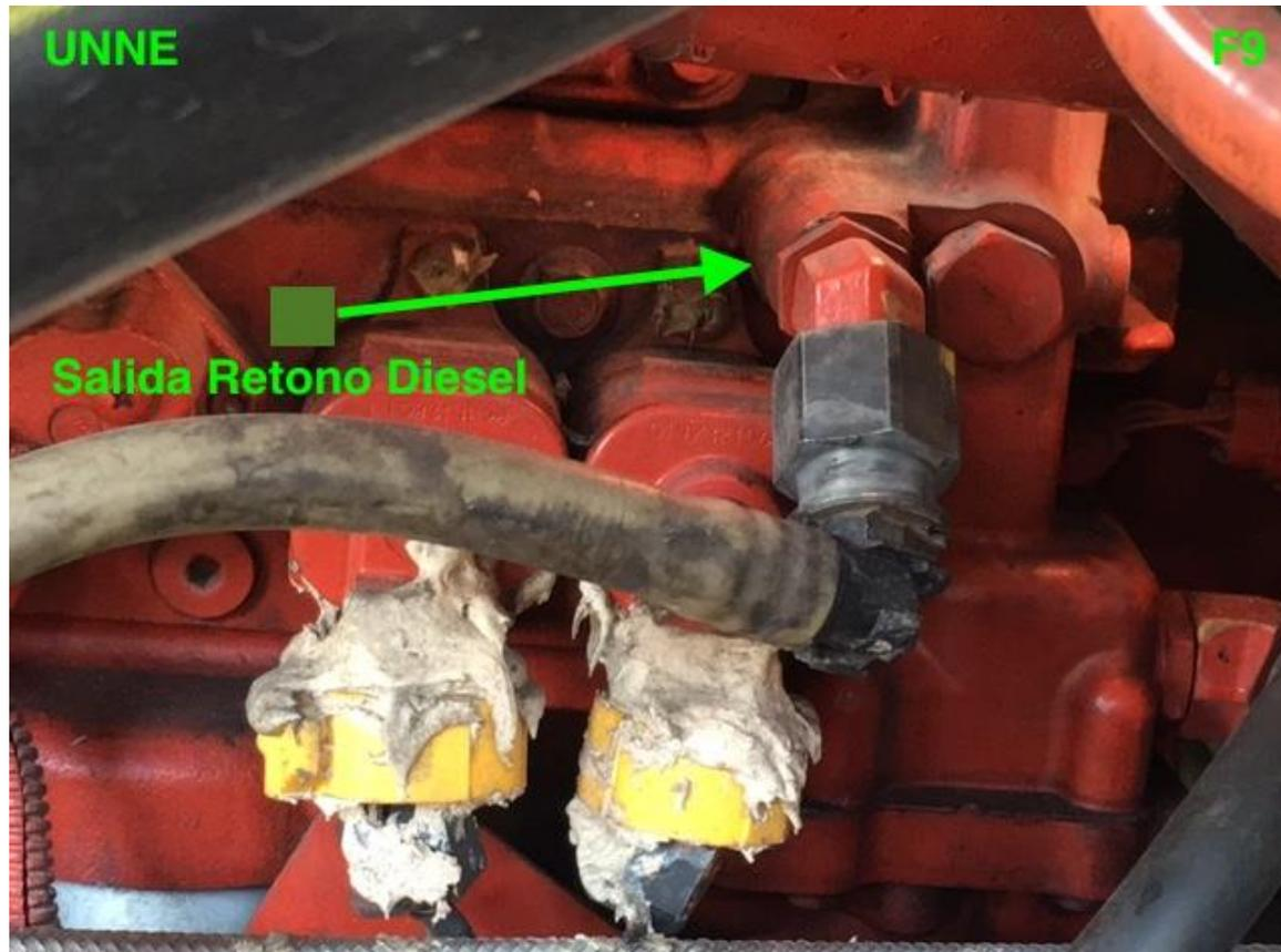
**Salida de del Diesel Retorno al Tanque Combustible**
